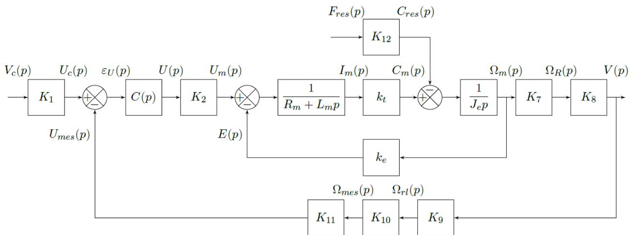
Figure 10 : Schéma-blocs de l'asservissement en vitesse du chariot
