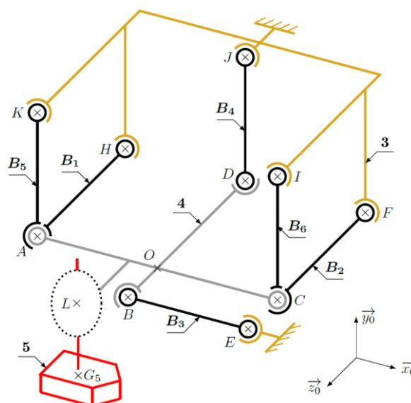
Figure 7 : Schéma cinématique 3D du dispositif de mesure
