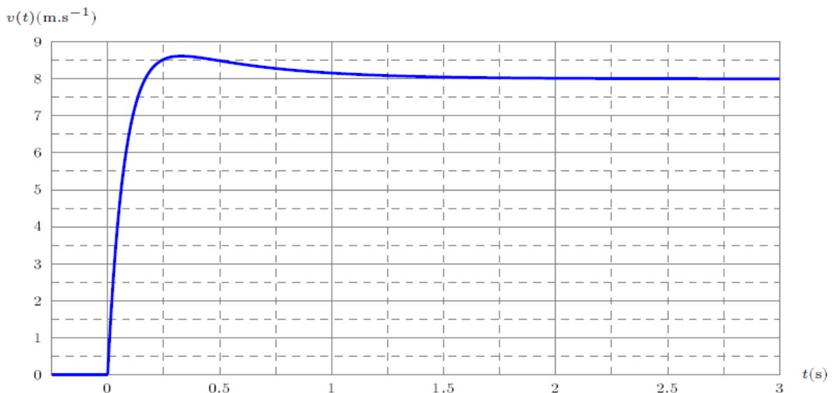
Figure 13 : Réponse à un échelon d'amplitude  $V_0 = 8 m.s^{-1}$ .
