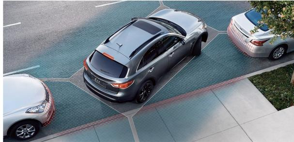
L'intervention du système de stationnement se fait sur la direction du véhicule : le système gère automatiquement l'orientation des roues avant du véhicule (et donc celle du volant). Quant au conducteur, il contrôle le déplacement du véhicule (marche avant ou arrière) et la vitesse du véhicule avec la pédale d'accélération. Cette vitesse est limitée et est supposée constante pendant la manœuvre.
