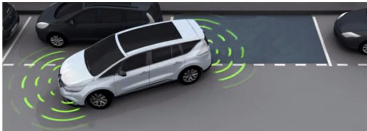
**Figure 1** Détection par ultrasons (4 capteurs)
