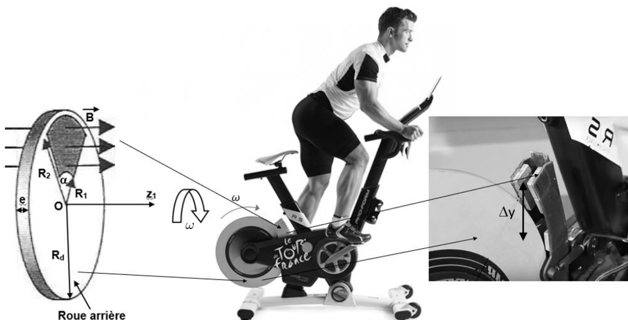
Figure 11 Mesure et modélisation du couple de pédalage
