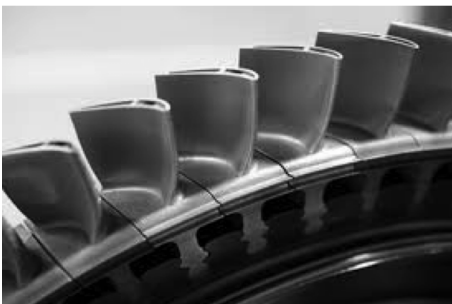
(a) Photo d'une partie de la roue à aube d'une turbine
