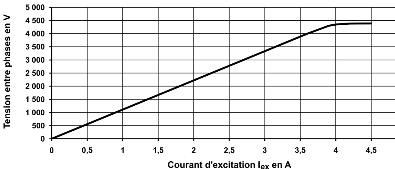
Figure 29 - Tension entre phases en fonction du courant d'excitation lors de l'essai à vide
