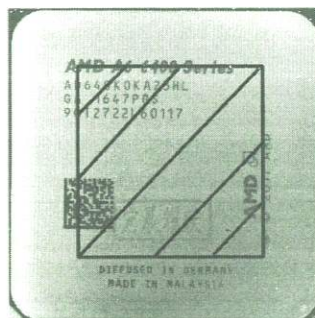
Figure 10 - Photographie d'une puce AMD A6-5400 et représentation de la surface utile S_u (carré hachuré)
