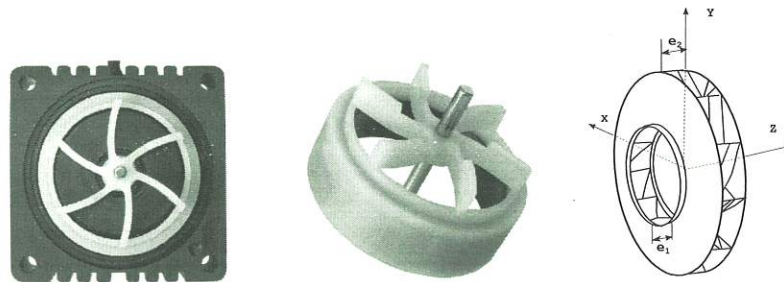
Figure 19 - Pompe centrifuge utilisée pour le refroidissement liquide
