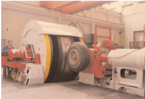
Figure 24 : Machine ADAMSON à inertie variable
