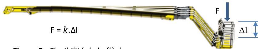
Figure 5 : Flexibilité de la flèche
