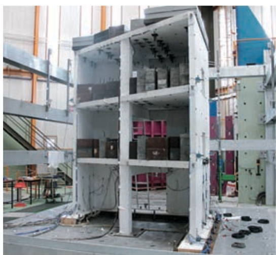
Figure 3 – Table AZALÉE avec une « maquette » de 9 m de haut d'un bâtiment en béton armé
