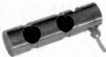
Afin d'améliorer les performances de la chaîne de mesure, on propose l'utilisation du conditionneur CPJ - CPJ2S. Celui-ci transmet un signal en 4/20 mA. Il filtre le signal du capteur. Nous prendrons en référence un capteur d'axe dynamométrique M16 de 4 tonnes avec une sensibilité de 1 mV/V. La valeur de la charge maximale à mesurer est estimée à 25 000 N. Le capteur est alimenté en 10 V. On consultera les **documents techniques DT7 et DT7 suite**.
