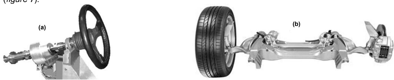
Figure 7 – Unité de pilotage (a) et unité de braquage des roues (b)
