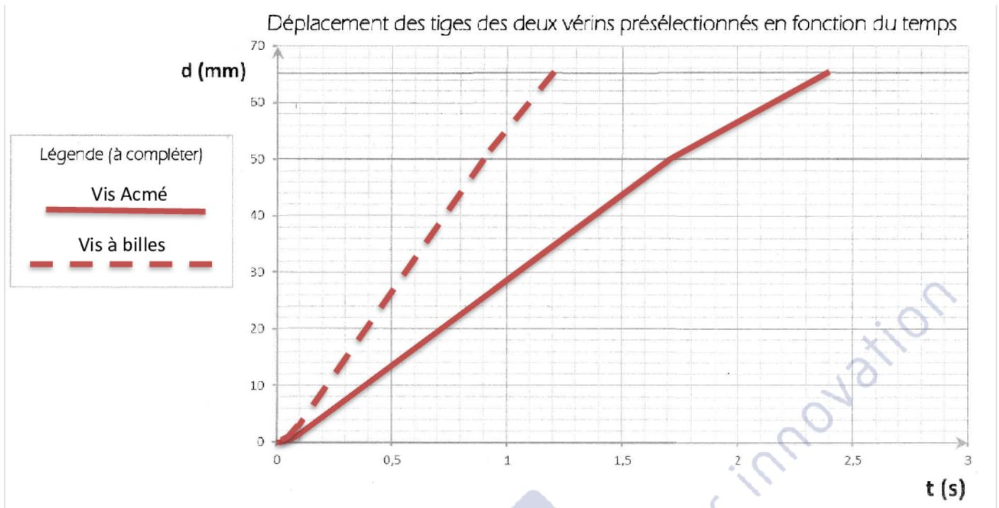
**Q 17 :** Aucun vérin à vis Acmé ne convient : le plus rapide donne un temps de verrouillage supérieur à 2s. Seul le vérin à vis à billes D •• -05B5 convient en termes de charge et de temps de verrouillage. Le vérin D •• -10B5 ne sera pas assez rapide (caractéristiques comparables à celles du D •• -10A5).
