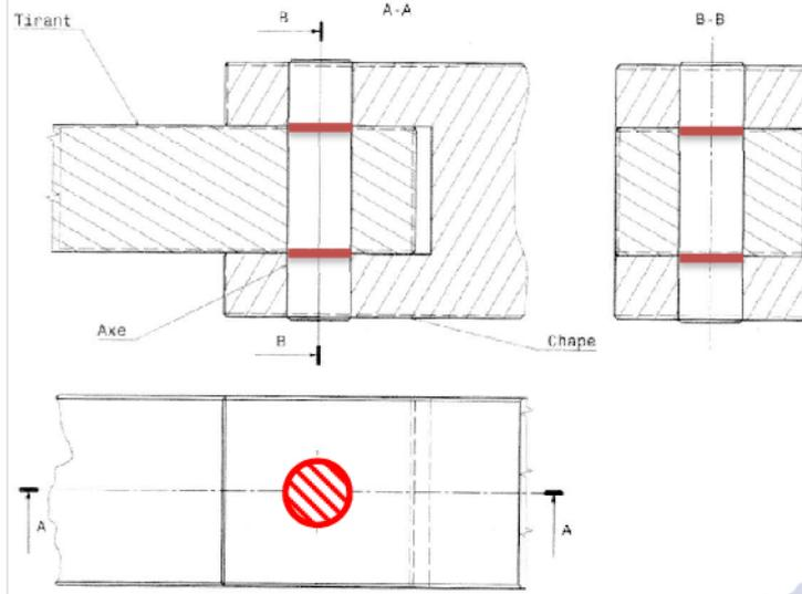
Condition de résistance au cisaillement de l'axe :
