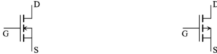
T7 et T8 : Transistor MOSFET à canal N      T9 et T10 : Transistor MOSFET à canal P
