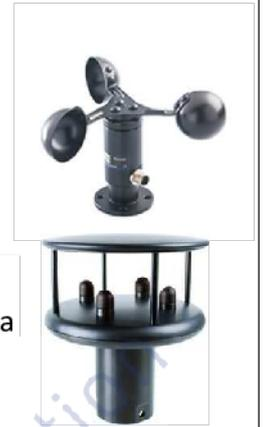
On peut aussi citer les anémomètres à ultrasons qui permettent en plus d'obtenir la direction du vent.
