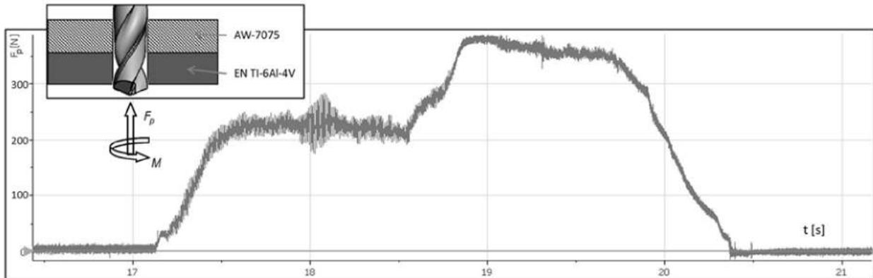
Exemple d'évolution de la force axiale lors du perçage d'un empilement de matériaux
