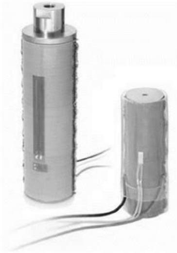
L'actionneur piézoélectrique utilisé est constitué d'un nombre  $n$  de couches de céramiques piézoélectriques empilées, placées en parallèle d'un point de vue électrique, capables de provoquer un allongement de la longueur de l'actionneur qui est proportionnel à la tension appliquée, lorsqu'aucun effort ne s'y oppose :
