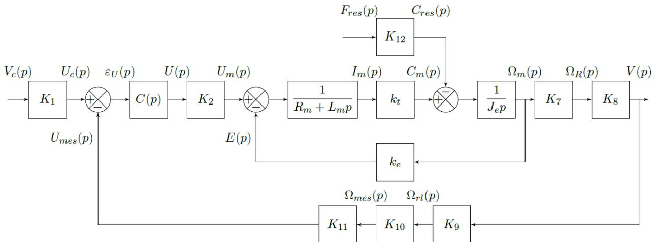
Figure 7 : Schéma-blocs de l'asservissement en vitesse du chariot
