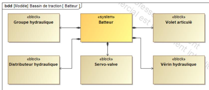
Diagramme de Définition de Blocs du batter
